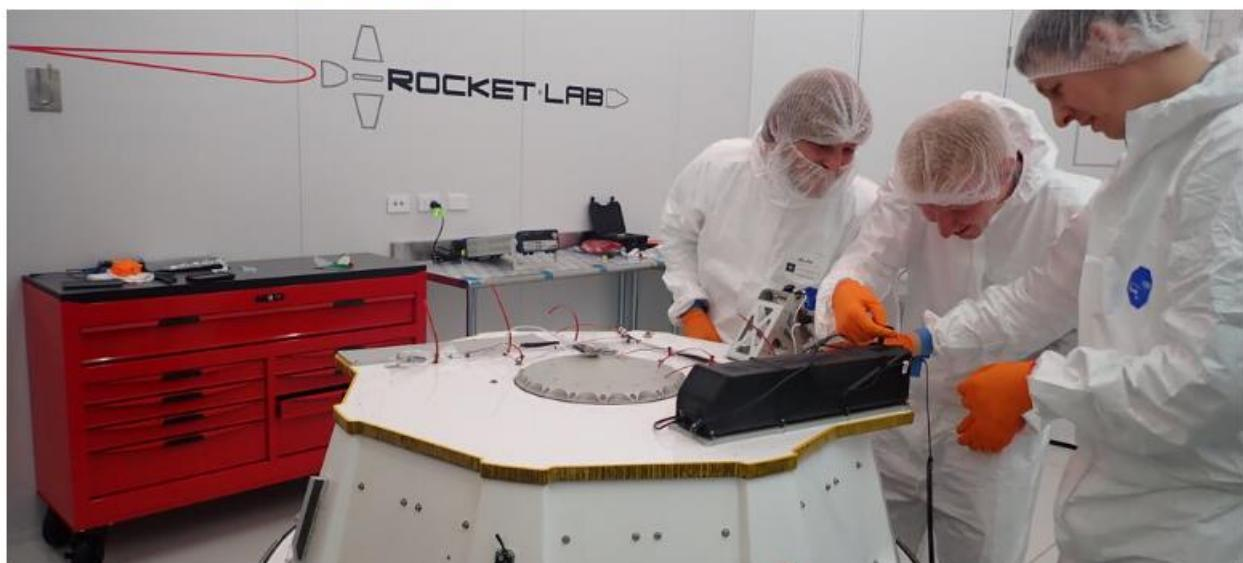
La société écossaise Alba Orbital, constructeur de satellites, a fait appel à la société italienne CRP Technology pour la construction d'AlbaPod 2.0, un déployeur de satellites entièrement réalisé par impression 3D. La technologie de fusion laser sur lit de poudre et le matériau Windform XT 2.0 ont permis de concevoir ces pièces.
