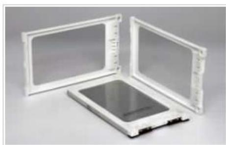
Il materiale plastico, non conduttivo elettricamente, rigido, resistente in temperatura e flame retardant ha soddisfatto a pieno le caratteristiche funzionali richieste per le custodie delle celle. In particolare, Windform FR2 garantisce l'**autoestinguenza necessaria in caso di anomalie**, che potrebbero sfociare in picchi di tensione temporanei con conseguente fusione localizzata, seguita da un principio di combustione.
