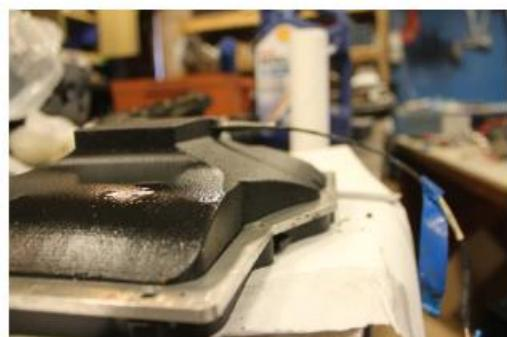
Les carters d'huile des véhicules de 2016, 2017 et 2018 ont été imprimés avec le matériau composite au carbone Windform® XT 2.0.
