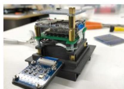
Montagetest der elektronischen Platine im Discovery 1a aus Windform XT 2.0.
